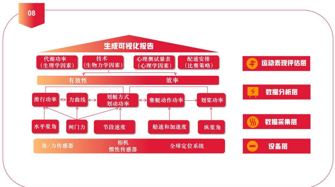
图 8 多传感器皮划艇训练信息集成分析系统（示例）
